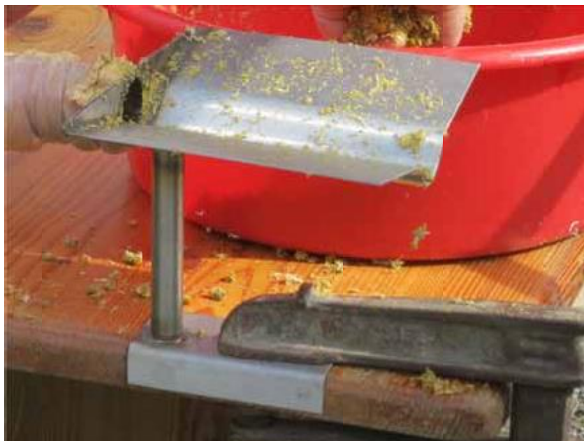
Imagen 3-6: Embudo para rellenar manzanilla, fijado a la mesa con una pinza
