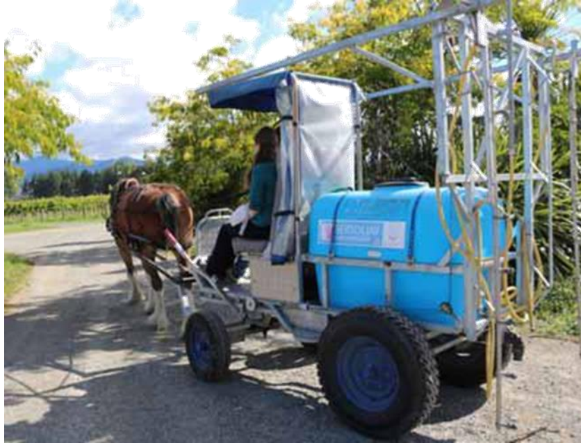
Imagen 15-4: La máquina de pulverización con tiro de caballos.
